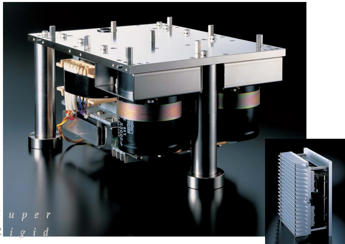
●独自の制振設計によるヒートシンク(特許出願中)
