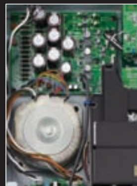
複数の大型コンデンサー、大型トイダル・トランスを組み合わせた強力な電源部
