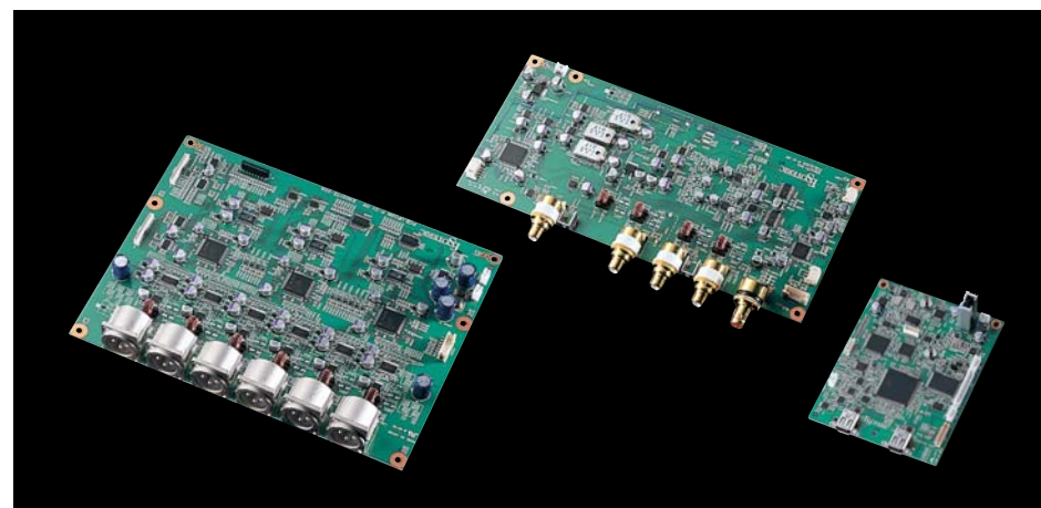
左:デジタルオーディオ出力基板 中:高精度水晶発振器搭載のクロック基板 右:i.LINK (IEEE1394)インターフェース基板 (D-01にも搭載)
