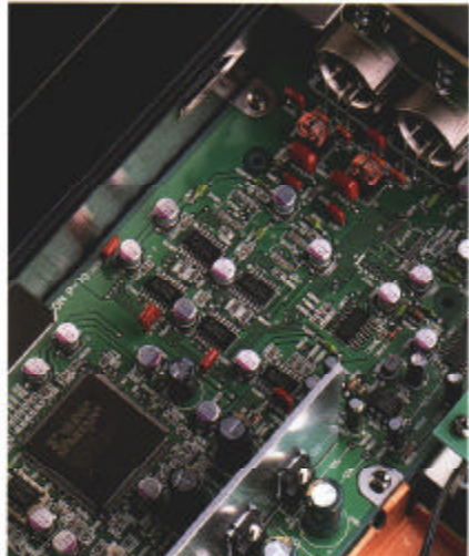
●アップコンバーター上部、この下に最短でサーボPCBを設置。
