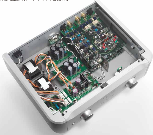
剛性の高い重量級肉厚アルミニウムシャーシと内部構成
