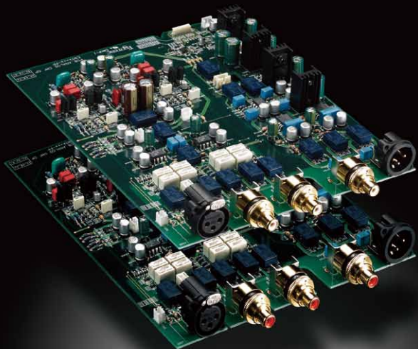
フルバランス、デュアルモノ設計の増幅回路
