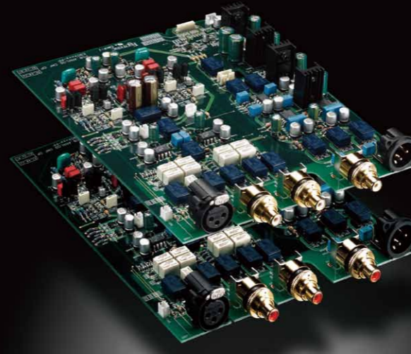
フルバランス、デュアルモノ設計の増幅回路
