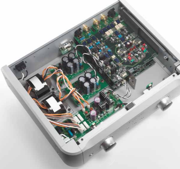
剛性の高い重量級肉厚アルミニウムシャーシと内部構成
