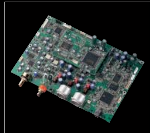
デジタルオーディオ出力基板とDSDコンバート基板(中央部)
