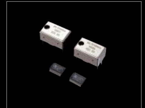
安定したクロックを供給する高精度VCXO(電圧制御水晶発振器) (奥) DSD・PCM対応のDAC「AD1955」(手前)
