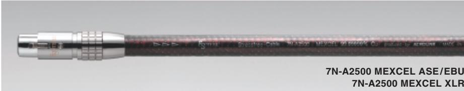
高純度7N銅の極薄平角線1本1本にMEXCEL被覆による絶縁処理を施した素線を編組し、更に特殊ストレスフリー加工を施した導体、シールドを採用しました。
