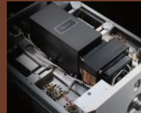
銅ワイヤに銀メッキを施した出力トランスの二次巻線
