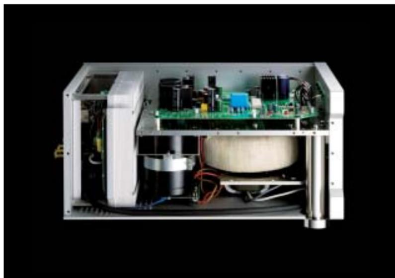
大容量1kVAのトロイダルトランス。瞬発する音楽信号が、この電源力を求めた。パワーアンプにおけるマスターサウンドワークス構想、エソテリックは電源部の徹底した強化から始めました。A-80はメイントランスに1kVAもの大容量トロイダルトランスを搭載し、スピーカーへの電流供給能力を劇的に向上。低ノイズ・低歪みに加え、高効率でハイパワー駆動が可能なトロイダルトランスが、すべての音楽信号に瞬時に追従します。さらにRコクトランスをサブに加えた2トランス構成を採用。大出力時でも回路の電源電圧の変動がないため、電圧増幅段の定電圧回路が省け、電源ラインをより純化することで開放的な音質を獲得しています。平滑用電解コンデンサには、電極用アルミ箔エッチング倍率の低い33,000 $\mu$ Fの大型タイプを±電源用に2個用い、余裕の大容量を実現。筐体内部を仕切る9mm厚銅板の上側に電圧増幅段とコントロール回路、下側にトランスを含めた電源部を配することで、整流時の電流ノイズの回路への混入を防
