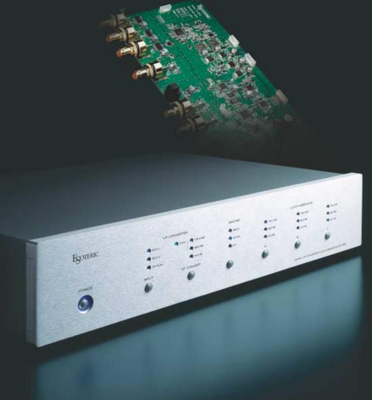
データを正確に時間軸に乗せること。これがデジタルオーディオの本質であり、また目標ともいえる基幹技術です。 ±1ppm 精度のワードクロックと最大192kHzのデジタルアップコンバート機能を搭載。 音像の見事な存在感と、抜けるような空間の透明感。いま、初めてのゾーンへ。
