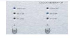
1.0ppm/0 ~50 )に優れ、1台1台厳密に調整され 中心周波数±1.0ppmにて選別された高精度水晶発振 器を搭載。これにより外部機器の基準クロックとなるワ ードクロックが生成されます。マスタークロックを 44.1kHz系列/48kHz系列から選択し、3系統あるワー ドクロックの出力は、それぞれマスターで選択した周波 数(44.1/48kHz)の1倍、2倍、4倍を選択可能です。倍 数は3系統独立して設定できますので、接続する機器に 合わせた出力が選べます。
