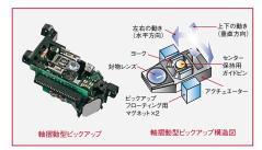
スーパーオーディオCDに刻まれた膨大な情報を、一点の曖昧さもなく読み取る。エソテリック独創の技術が、かつてない音楽感銘をもたらしました。フラッグシップモデルP-01やP-03で絶大な評価を集めた高性能軸摺動型ピックアップ採用のVOSP\*メカニズム。レーザーの光軸が絶えず垂直を維持して傾きを発生しない構造により、きわめて高精度な信号読み取りを実現。これらのオリジナルメカをはじめ、ハイエンドシーンで培った多様なノウハウを随所に投入しています。
