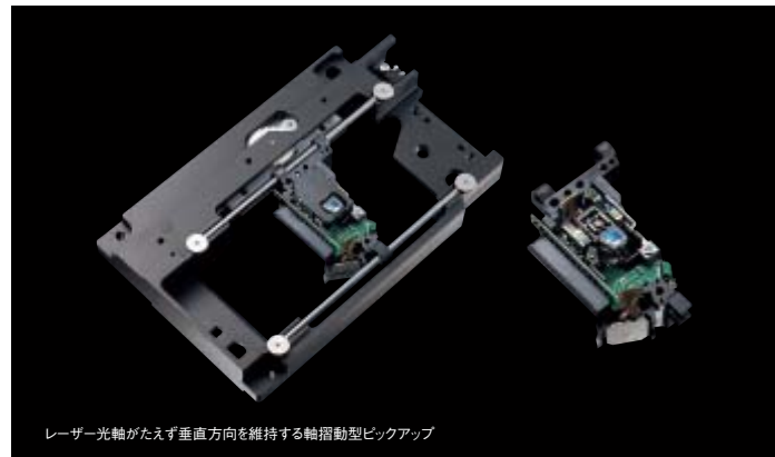
ピックアップ移動用にティアックオリジナルのホール素子検出型3相ブラシレスモーター(右)を搭載した速度帰還制御スレッド送り部分
