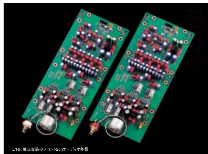
L/Rに独立実装のフロント2chオーディオ基板
