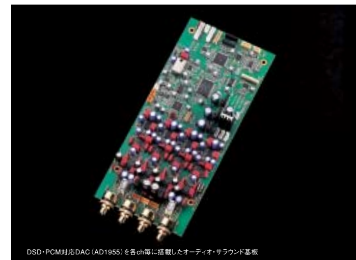
DSD・PCM対応DAC (AD1955) を各ch毎に搭載したオーディオ・サラウンド基板
