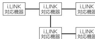
信号を出力した機器に、同じ信号が戻ってしまうと動作しません。接続が輪(ループ)にならないように注意してください。
