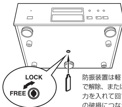
防振装置は軽く少し回すだけで解除、または固定できます。力を入れて回すと、防振装置の破損につながりますのでご注意ください。
