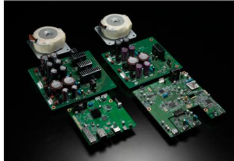
ESOTERIC Network Engine G4 (左手前)、デジタルオーディオ回路 (右手前)、それぞれに独立した専用大型リニア電源を搭載
