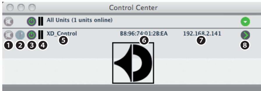
Avantgarde XD-Series Control アイコンをクリックすると、まず Control Center が開きます (図 1)。接続済みで電源が入っている全サブウーハーがリスト表示されます。All Units 以下の括弧内には、オンラインのサブウーハー数が表示されます。接続されているサブウーハーごとに、ステータスライン下に詳細が表示されます。
