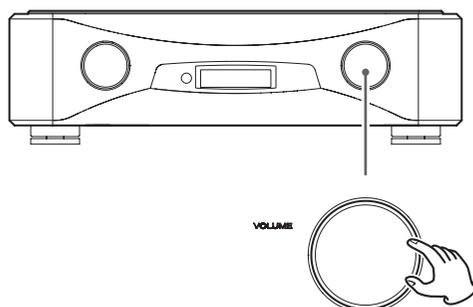
⚠ 突然大きな音が出ると、聴力障害などの原因になることがあります。音量は最小にしておいて、音を出してから適切な音量に調節するようにしてください。
