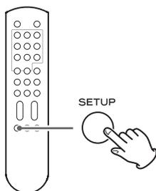
セットアップボタン (SETUP) を押す度に、ディスプレイの表示が変わります。
