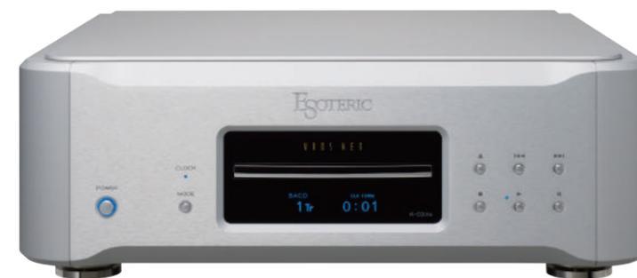
一体型の最高峰 Grandioso K1 や K-01Xs に息づくハイエンドの思想とテクノロジーを受け継ぎ、ハイパフォーマンスモデルとしてどこまで高次元に昇華し得るか。K-03Xsはその卓越した回答です。定評のVRDS-NEO [VMK-3.5-10]ドライブメカニズムは、VS-DD回路を搭載し、滑らかで静粛なスピンドル駆動を可能にしました。Grandioso K1 に採用された新しいDACプラットフォームをベースに開発された、差動4回路/chの平行/ディファレンシャル構成のデュアルモノDACを新たに搭載し、ESOTERIC独自の特許技術、34bit D/A プロセッシングアルゴリズムを採用。最新デバイスの数々、DSD対応USBなど、音質・機能の要となる部分に、フラッグシップモデルから継承されたエッセンスを活かし、あますところなく結実させています。
