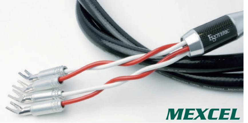
MEXCEL 平角編組導体を採用し、GHzまでフラットな伝送特性を獲得。高 S/N でパワフルな 4 芯スター カッド構造+シールド仕様。ベリリウム銅 50 バナナ プラグ、または 6N Cu スペードコネクターをオーダー時にご指定（仕上：銀+ロジウムメッキ）。
