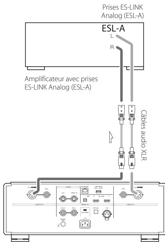
Utilisez des câbles XLR pour raccorder les prises de sortie audio analogique (XLR/ESL-A) de cette unité aux prises ES-LINK Analog (ESL-A) d'un amplificateur.
