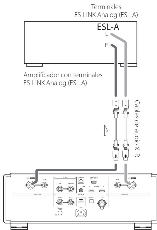
Utilice cables de audio XLR para conectar los terminales de salida de audio analógico (XLR/ESL-A) de esta unidad a un amplificador que tenga terminales ES-LINK Analog (ESL-A).
